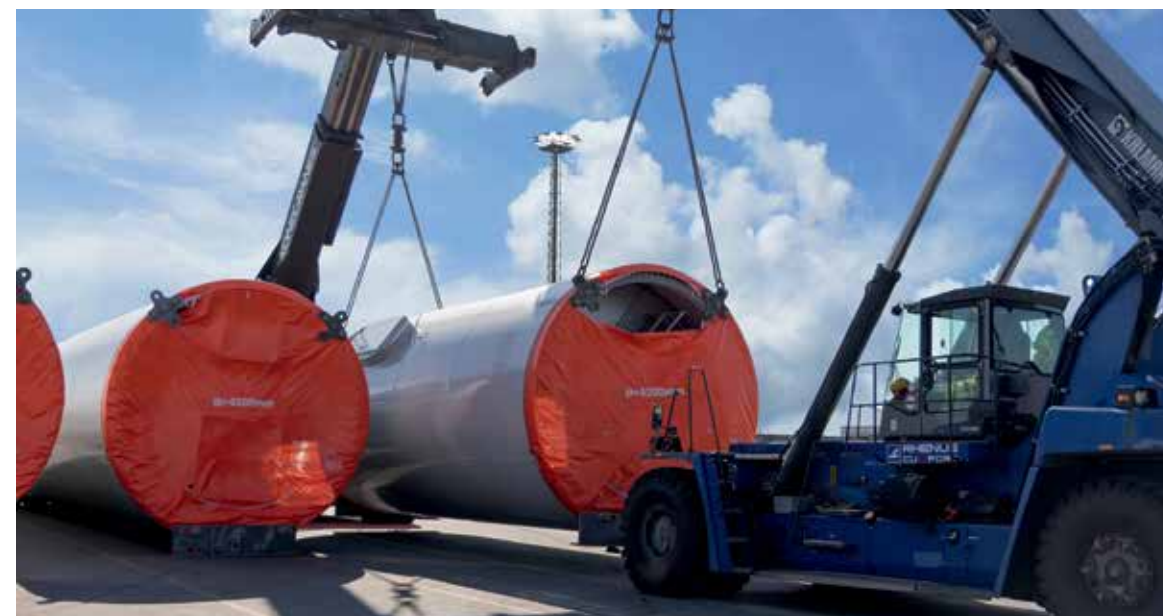
In Cuxhaven werden alle Großkomponenten für Offshore-Windkraftanlagen umgeschlagen, darunter auch die Turmsegmente.
